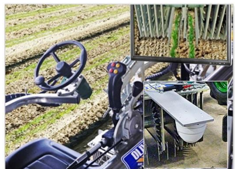
SISTEMA DI GUIDA MANUALE CON TELECAMERA + MONITOR DA 24" Una telecamera HD ad alto contrasto di luce, montata davanti a 2/3 file seminate, proietta le immagini su un monitor da 24" posizionato in cabina.
